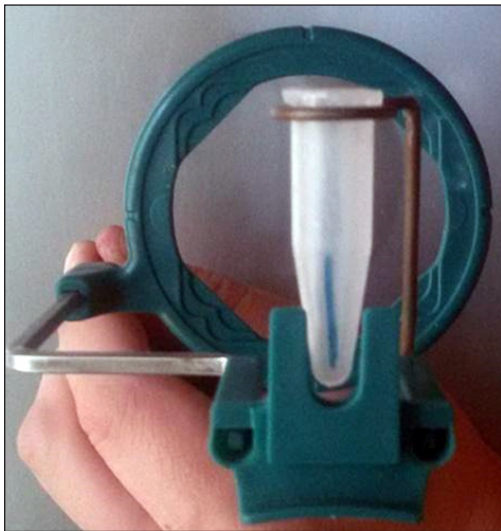
Figura 1. Sistema para posicionar las muestras para la toma radiográfica inicial y final
