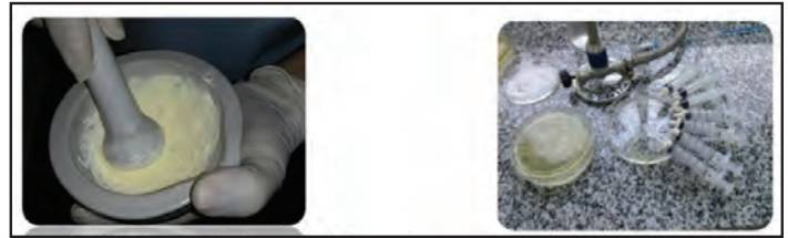
Fig. 3. Preparación de pastas alcalinas y almacenamiento en jeringas esteriles rotuladas con el número correspondiente a cada formulación.
