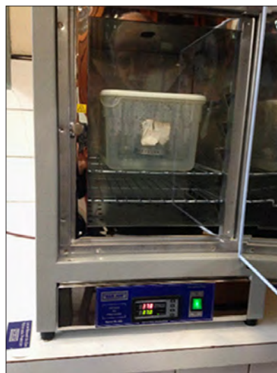
Fig. 6. Estufa a 37°C y 99% HR.
