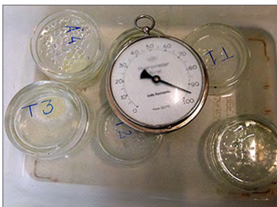
Fig. 5. Discos sumergidos en agua desgonzada.
