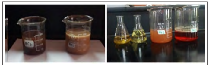
Figuras 3 a y b: a) Extractos acuosos de corteza externa e interna; b) Extractos hexánicos y etanólicos de corteza externa e interna de M.indica .
